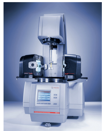
Bild 2. Festkörpereinspannvorrichtung (Solid Rectangular Fixture; SRF) für die temperaturabhängige DMA von additiv gefertigten PEEK-Stäben am MCR 702 MultiDrive Rheometer mit einem Konvektionsofen (CTD 600 MultiDrive ready) (© Anton Paar)
